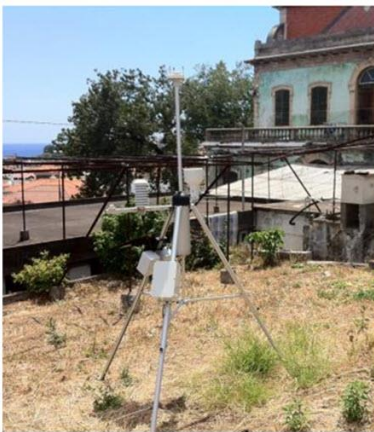
Figura 7 – Estação meteorológica automática instalada no centro da freguesia de Santa Luzia.
